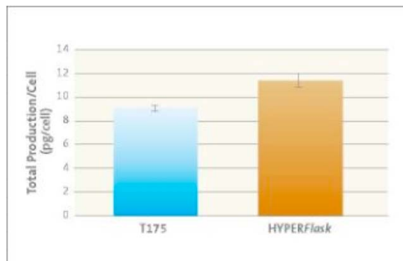
Figure 3. Production moyenne de MCSF par cellule après 96 heures en T175 et en HYPERFlask™ Cell Culture Vessel.
